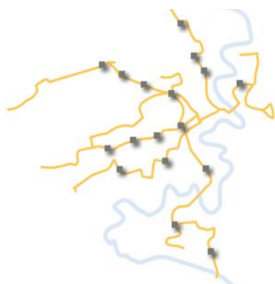
Figure 44: Carrefours à feux régulés entre eux (gris) pour la priorisation des bus (jaune), en complément du contrôle d'accès (cf. chapitre 7.3)
