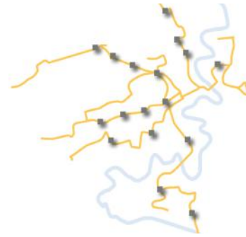
Abbildung 44 : Kreuzungen mit untereinander regulierten Ampeln (grau) zur Priorisierung der Busse (gelb), zusätzlich zu den Zugangskontrollen (s. Kapitel 7.3)
